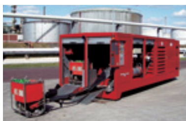
Hydrosub pump unit 大量送水システム・ポンプユニット
