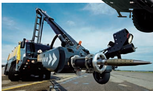
穿孔装置付空港用化学消防車
