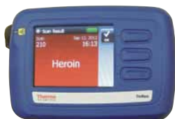
携帯型薬物分析器 Thermo Fisher Scientific TruNarc
