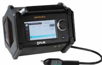
可搬型ガスクロマトグラフ/質量分析計 TELEDYNE FLIR Griffin G510
